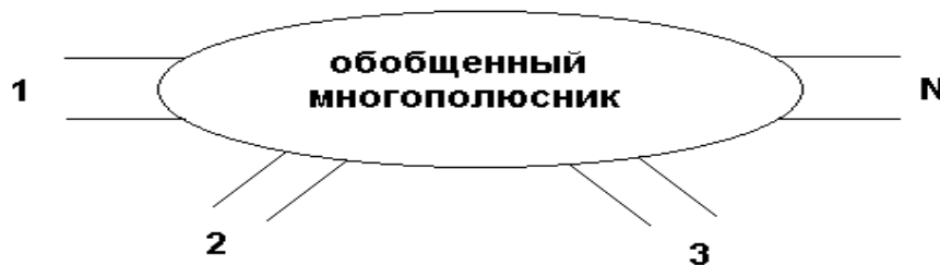
Рис. 3. Представление СВЧ схемы в виде многополюсника
