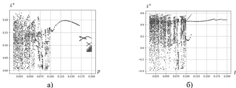
Рис. 1. Бифуркационные диаграммы по частотному параметру  $p$  для значений параметров  $\mu = 0,1; R = 0,3; \lambda_1 = 0,2; \lambda_2 = 0,3; \gamma = 4; \varepsilon = 0,018; \varphi = 0,52$ .
