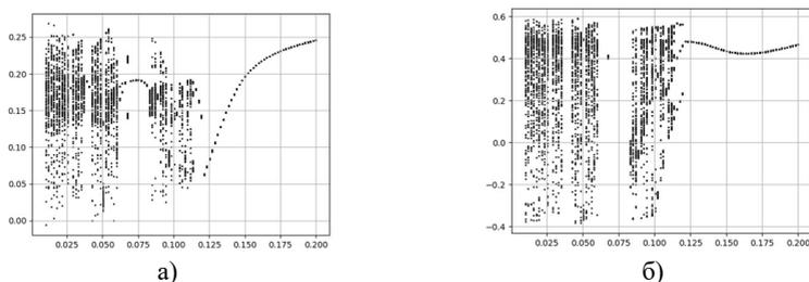
Рис. 2. Бифуркационные диаграммы по частотному параметру  $p$  для значений параметров  $\mu = 0,1; R = 0,3; \lambda_1 = 0,2; \lambda_2 = 0,3; \gamma = 4; \varepsilon = 0,018; \varphi = 1,5$ .
