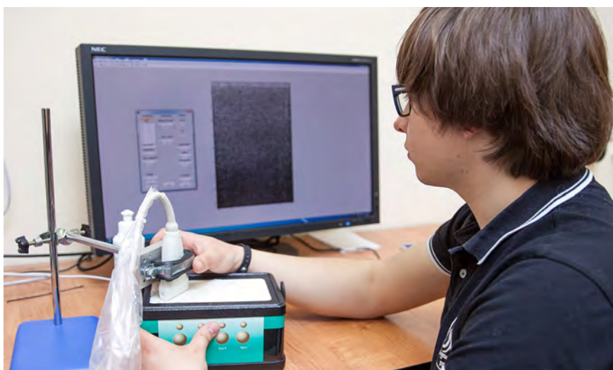
Исследование полимерного фантома CIRS на акустической системе Verasonics в лаборатории кафедры акустики
