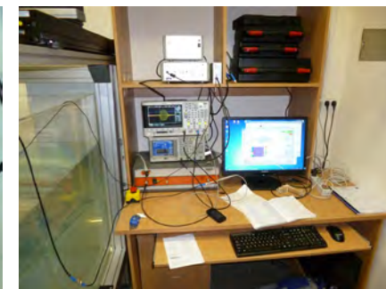
Измерительная система на основе волоконно-оптических гидрофонов - ФОН/1, с комплектом заменяемых оптоволоконных датчиков производства PRECISION ACOUSTICS LTD (Великобритания)
