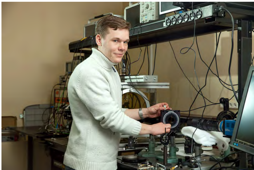
Установка для анализа нелинейных волн методом Шлирен-визуализации в лаборатории кафедры акустики
